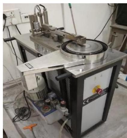
Fig.5: Pin-on-disk Wear test rig.
